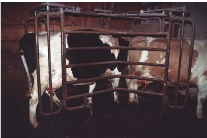
Abb. 20: Krafftutterautomat mit vorderem Ausgang, geschlossene Türen und Seitenabtrennungen würden noch besser vor Hornstößen schützen.
